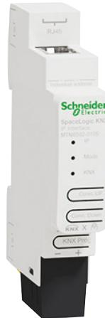
Das SpaceLogic KNX/IP Interface ist eine Schnittstelle zwischen IP und KNX. Man kann von jedem Punkt des LAN-Netzes auf den Bus zugreifen. Das SpaceLogic KNX IP Interface kann als Programmierschnittstelle für die ETS 5 Software verwendet werden und ermöglicht den Zugriff auf den KNX-Bus über das Internet über ein VPN. Das Gerät unterstützt KNX Security. Diese Option kann durch die Software ETS aktiviert werden.
