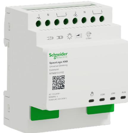
Zur unabhängigen Steuerung von bis zu 2 dimmbaren Lasten wie dimmbare LED-Lampen, Glühlampen, HV-Halogenlampen, NV-Halogenlampen unter Verwendung von dimmbarengewickelten Transformatoren oder elektronischen Transformatoren oder dimmbaren Kompakteuchtstofflampen. Alle Ausgänge können manuell über Taster bedient werden. Die ETS-Programmierung wird in der ETS-Anwendung des Masters durchgeführt.
