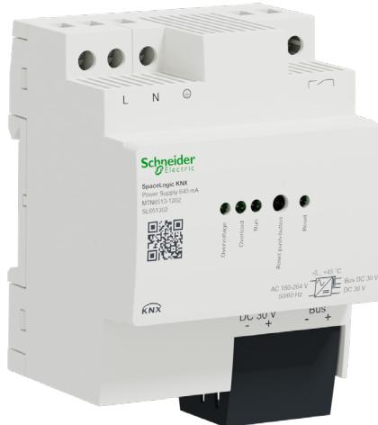
Das Stromversorgung SpaceLogic KNX erzeugt die Busspannung für die KNX-Leitung. Die Stromversorgung hat zwei Ausgänge: einen KNX-Ausgang mit integrierter Induktivität und einen 30 V DC-Ausgang für Zusatzgeräte. Zwei identische Stromversorgungen können parallel geschaltet werden, um den Ausgangsstrom zu verdoppeln.
