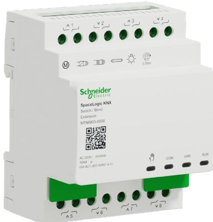
Die SpaceLogic KNX Erweiterung Schalt/Jalousie ist ein Schaltaktor, der die Kanäle eins SpaceLogic KNX Master - Moduls (Schalt/Jalousie o. Dimmer) erweitert. Zur unabhängigen Steuerung von bis zu 4 Jalousie-/Rollladenantrieben oder zum Schalten von bis zu 8 Lasten. An den Master können höchstens 2 Erweiterungen angeschlossen werden. Der Master steuert die Erweiterungen sowie deren Stromversorgung und die Verbindung mit dem Bus. Die ETS-Programmierung erfolgt in der ETS-Applikation des Master.
