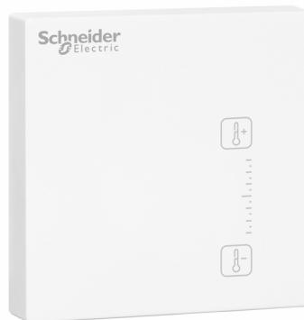
Das Gerät ist ein kombinierter Sensor für CO<sub>2</sub>-, Temperatur- und Feuchtemessung (relative Feuchte) und Luftdruck mit integrierter Temperaturregelung für einen Bereich. Der Benutzer kann einen Standard-Einstellbereich von  $\pm 3$  °C in Schritten von 0,5 °C verwalten. Der Multisensor überwacht die Luftqualität in Räumen, zum Beispiel in Schulen oder Büros. Die Messdaten werden zur Verarbeitung über den KNX-Bus gesendet.
