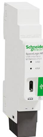
Zum Anschluss eines Programmier- oder Diagnosegerätes mit einer USB-Schnittstelle an den KNX. Der USB-Stecker (Typ C) ist vom KNX-Bus galvanisch getrennt. Er kann als Programmierschnittstelle für die ETS Software Version 4 (oder höher) verwendet werden. Das Gerät wird lokal mit der physikalischen Adresse programmiert und verfügt über keine Programmertaste und keine Programmier-LED. Mit 2 Status-LEDs.
