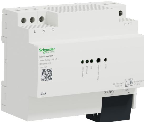
Das Stromversorgung SpaceLogic KNX erzeugt die Busspannung für die KNX-Leitung. Die Stromversorgung hat zwei Ausgänge: einen KNX-Ausgang mit integrierter Induktivität und einen 30 V DC-Ausgang für Zusatzgeräte.
