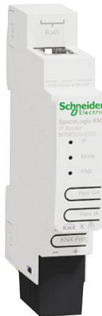
Der SpaceLogic KNX/IP-Router ermöglicht die Weiterleitung von Telegrammen zwischen verschiedenen Linien über ein LAN (IP) als schnellen Backbone. Das Gerät kann zusätzlich als Kommunikationsschnittstelle verwendet werden, um einen PC an den KNX-Bus anzuschließen (z. B. für die Programmierung mit der ETS-Software oder eConfigure KNX).
